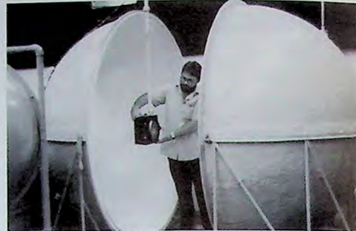
Vista geral do atual laboratório de fotometria - Esfera de Ulbricht, Ø2m
